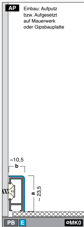
G23-10-E Höhe: 23,0 mm Breite: 10,0 mm Länge: 2,0 / 2,5 / 3,0 m
